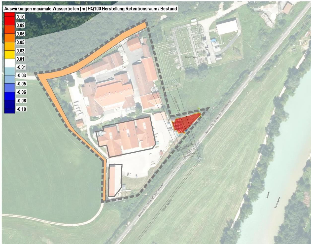
Abbildung 4.6: Auswirkungen maximale Wassertiefen: HQ<sub>100</sub> Saalach. Herstellung Ausgleichsvolumen
