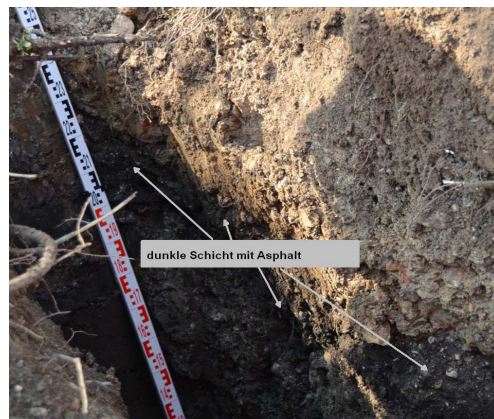
Abbildung 9: Foto Bodenaufschluss Schurf Nr. 4 mit Benennung der angetroffenen Bodenschichten und Bodenprobe 1 und 2
