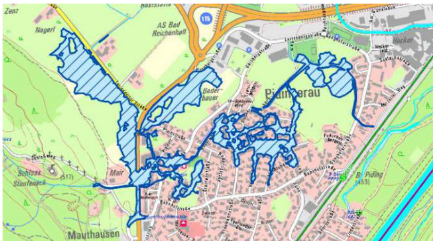
Abb. 61 Vorläufige Sicherung des Überschwemmungsgebietes HQ100, Wildbach Schlossberggraben
