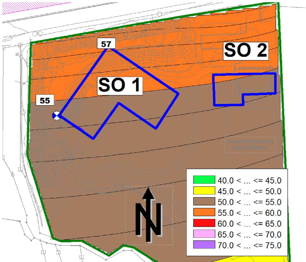
Wie das Ergebnis in Abbildung 6 zeigt, wird der  $IRW_{TAL\text{Lärm}}$  von 55 dB(A) tags für ein WA im nördlichen Bereich des Plangebiets um bis zu 2 dB(A) überschritten (orange Fläche). Betroffen wäre ein Teilbereich der Nordwest- und Nordostfassade von SO 1 und die Nordfassade von SO 2. Der  $IRW_{TAL\text{Lärm}}$  von 60 dB(A) für ein MI könnten durchgängig eingehalten werden.
